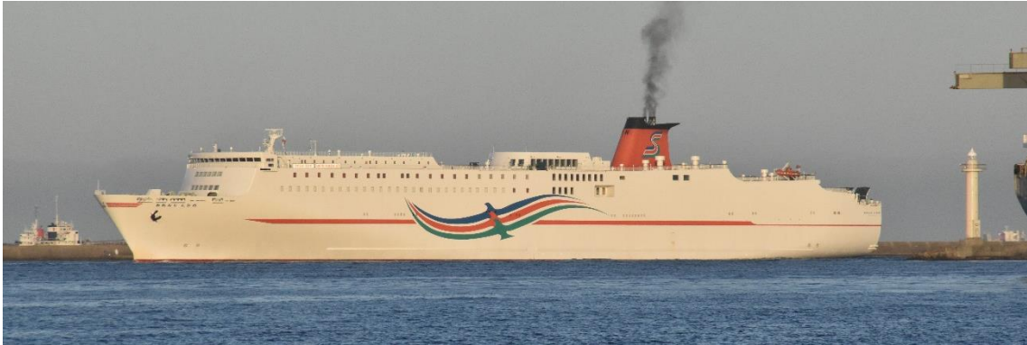
東予から到着した四国開発フェリーの「フェリーえひめ」です。長さが 200m 未満ぎりぎりの瀬戸内マックス型です。
